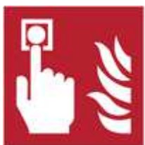
pulsante di allarme antincendio
